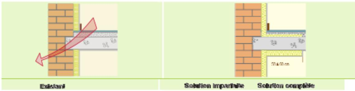
Exemple de rupture de pont thermique :
