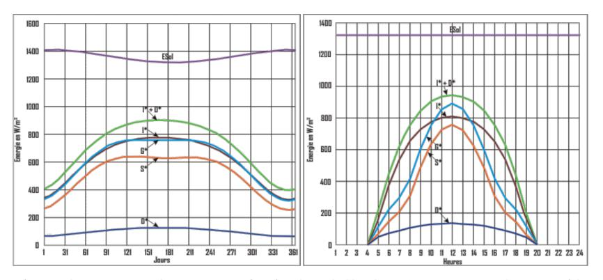
L'énergie solaire qui arrive sur le capteur est représenté par la courbe bleu clair (G\*), avec un capteur solaire motorisé, la courbe G\* serait égale à la courbe I\* + D\* (vert clair) soit, pour l'exemple ci-dessus, 14,2% sur l'année et 28,6% sur la journée.
