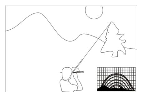
Dans le cas où il n'est pas possible de se positionner à l'endroit où seront installés les capteurs solaires, il est possible de déporter le point de mesure mais dans ce cas, il sera nécessaire de calculer les angles de hauteur et d'azimut de façon à avoir les bons angles du point de référence. Pour la hauteur (croquis 1, Angle de hauteur du masque) la formule est :
