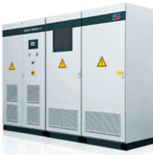
Ces onduleurs sont typiquement utilisés pour les grandes centrales PV au sol ou sur bâti, de plusieurs centaines ou milliers de kWc. Leurs tension d'entrée sont de quelques centaines de volts et l'injection sur le réseau électrique est en triphasé.
