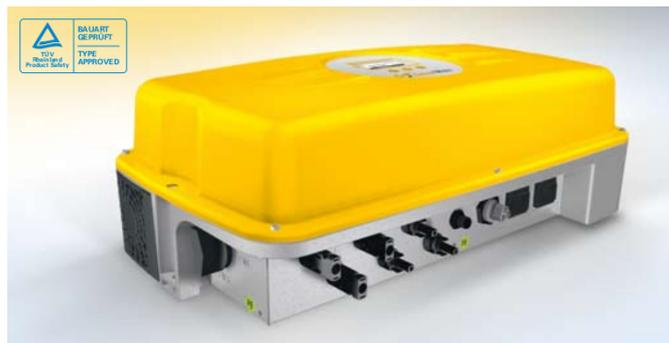
Ces onduleurs sont eux utilisés pour de petites ou de moyennes installations photovoltaïques, de quelques kWc à quelques centaines de kWc. L'onduleur est connecté à une ou éventuellement plusieurs chaînes (ou string) de modules PV. Leur tension d'entrée sont de quelques centaines de volts et l'injection sur le réseau électrique est en mono ou en triphasé.
