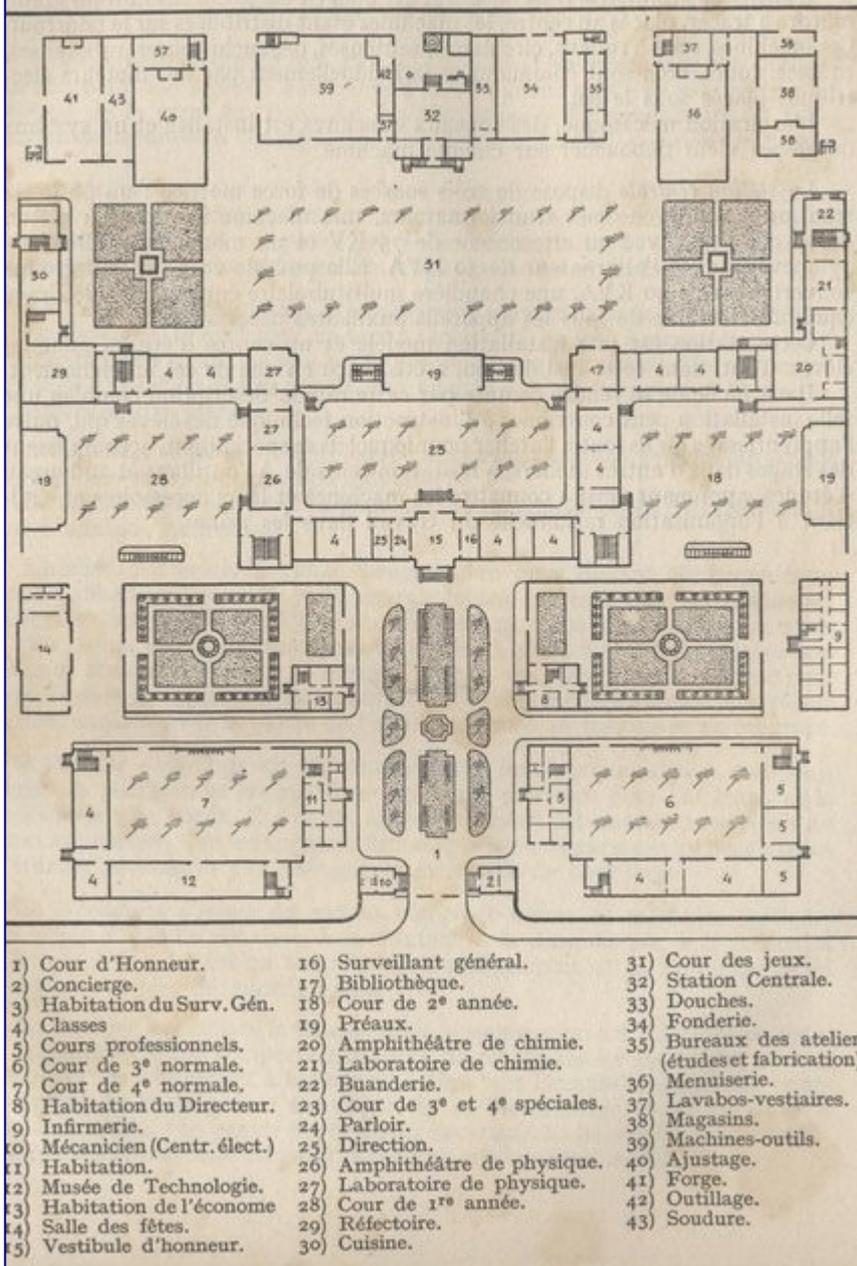
**Les ateliers sont dans l'ordre suivant : forge, soudure, ajustage, électricité, machines-outils, outillage, station centrale, -thermique, fonderie, menuiserie et modelage. Ils sont complétés par le bureau d'études et de fabrication, le laboratoire d'essais des métaux, les magasins au fer et au bois.**
